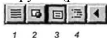
Рис. 5.12. Кнопки переключения режимов отображения документа на экране: 1 — Обычный режим; 2 — режим Разметка страницы; 3 — режим Web-документ; 4 — режим Структура
