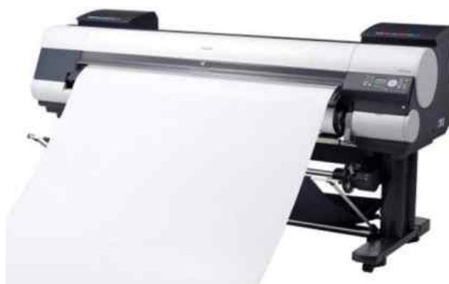
Рис.7. Барабанный (рулонный) плоттер
